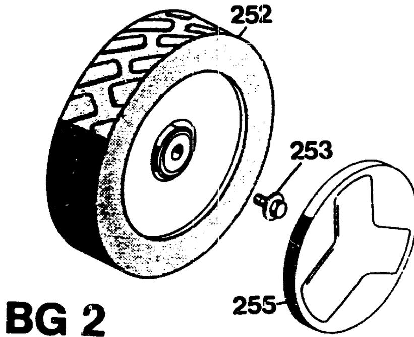
Hinterrad-Antrieb 200 mm Ø - Standard -
