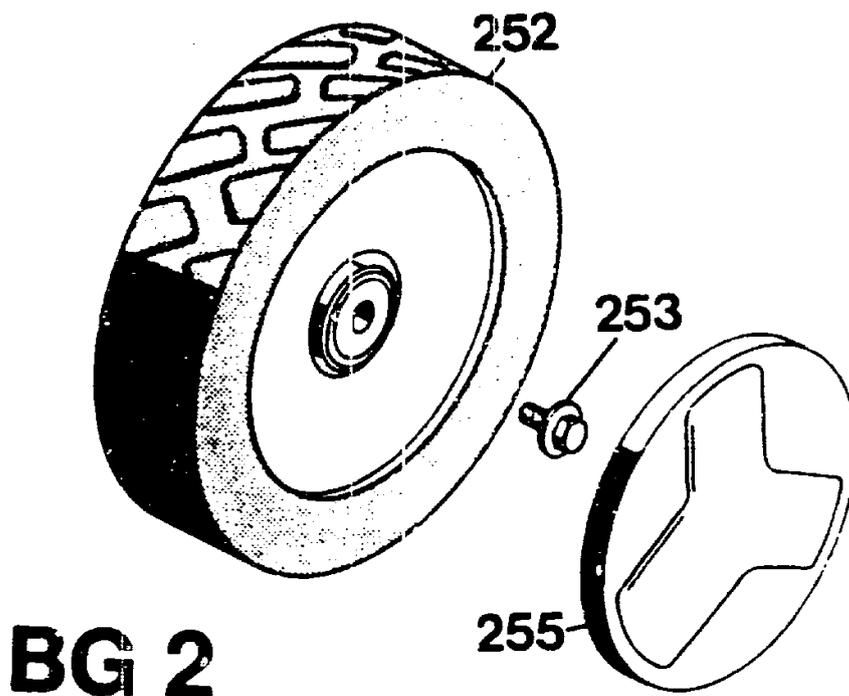
Hinterrad-Antrieb 200 mm  $\phi$  - Standard -
