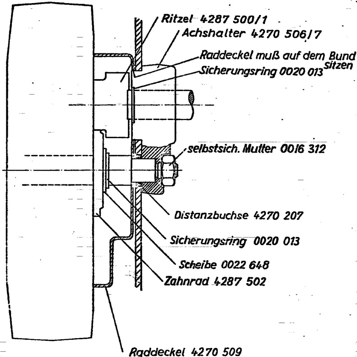
Bei der Montage des Hinterrades bitte unbedingt darauf achten, daß der Raddeckel auf dem Bund der Achsschwinge sitzt. Dazu die Achsschwinge ganz nach außen gegen den Sicherungsring drücken. Die Distanzbuchse 4270 207 darf nicht vergessen werden. Zur Befestigung der Achse wird ausschließlich die vorgeschriebene Mutter verwendet. Wenn der Raddeckel schleift oder das Rad abgeht, wurde etwas falsch montiert.
