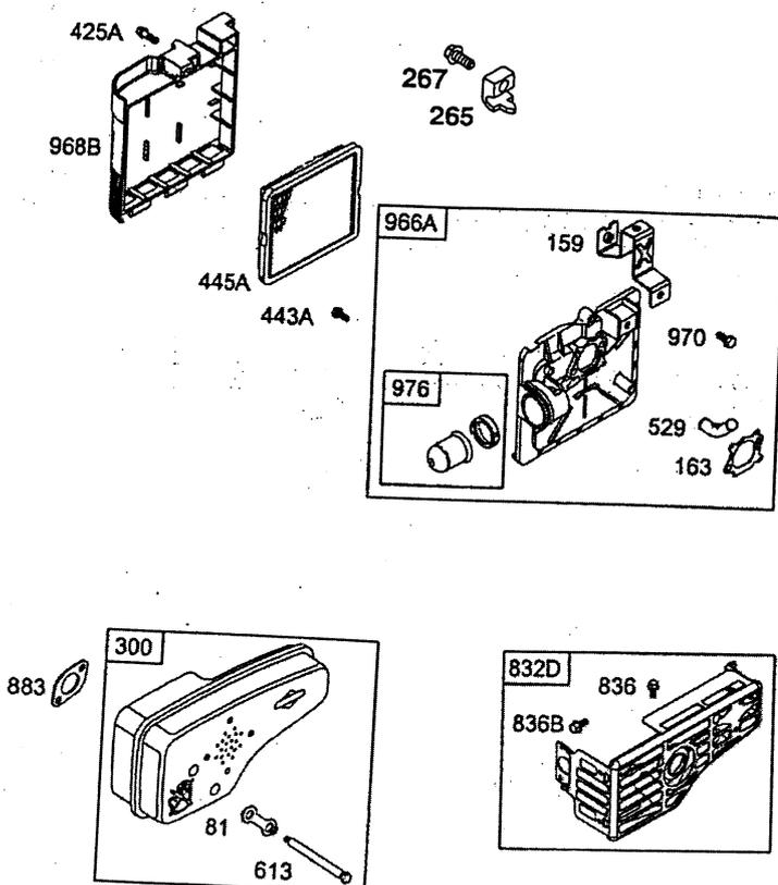
**Quantum 55 XTE Luftfilter, Schalldämpfer**
