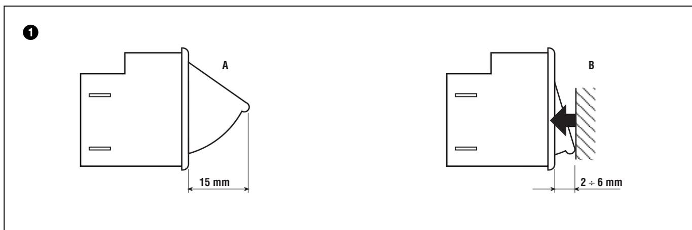
La regolazione del micro di sicurezza **(1)** del sedile deve essere effettuata esclusivamente variando la posizione della camma **(2)**, dopo aver allentato le due viti di fissaggio **(3)**.
