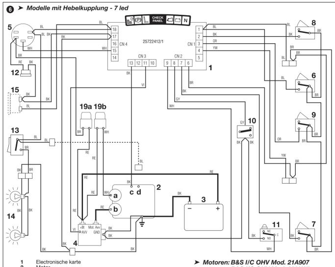
2 2a Motor Generator Anlasser 2b 2c 2d Motor Abstellung Vergaser (falls vorgesehen) 3 Batterie Anlasserelais Schlüsselschalter Messer Mikroschalter
